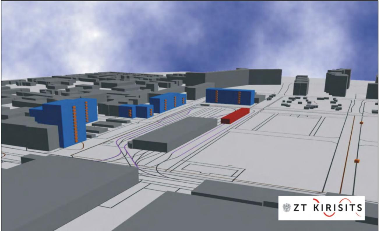
**Abb. 13:** 3D-Ansicht des digitalen Berechnungsmodells mit der Remise und der Nachbarschaft (Zustand mit Freiabstellanlage – Variante 10)
