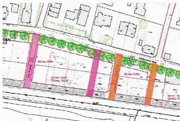
Abbildung 3: Auszug planliche Darstellung zum Bebauungsplanentwurf 17.26.0, pink und orange Flächen zeigen die aktuell geplanten sowie die möglichen nach Süden versetzten Geh- und Radwege
