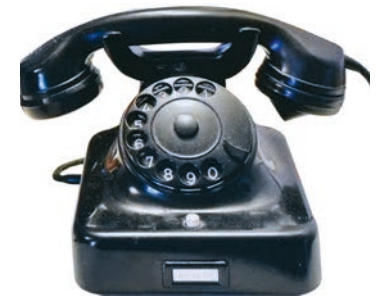
1936. Tischgerät-Telefon mit Wählscheibe Modell W36 (1936). Bis Ende der 1950er-Jahre war es in Österreich in Betrieb.
